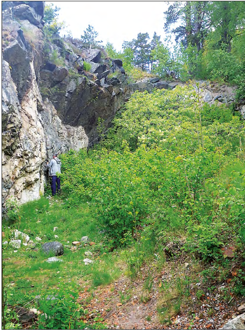
Figur 6. Helmut Bergold mäter in dagbrottet. På bilden syns de båda brytningsteknikerna tillmakning och sprängning tydligt. Den del som bildar överhäng är den tillmakade medan sprängning använts i den nedre delen. Bilden är tagen från söder. Foto av Arkeologgruppen AB.
