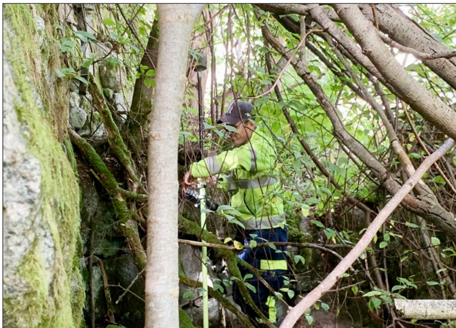
Figur 9. Inmätning av smedjan (objekt 12) vid åns södra sida. Tät vegetation försvårade arbetet med inmätning då växtligheten försvårade för GPS:ens mottagare att fungera korrekt.
