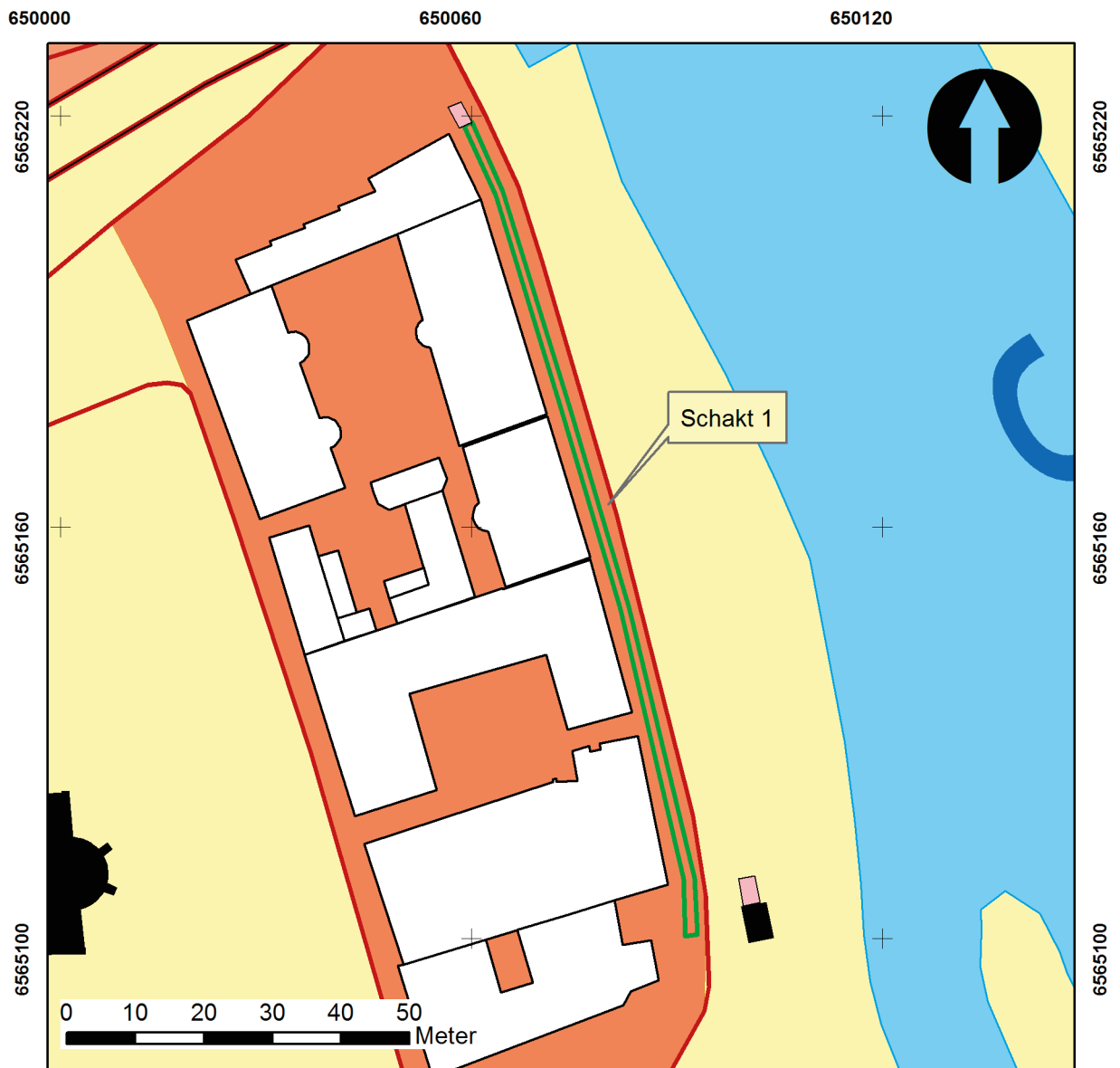
Figur 3. Plan över schakt 1. Schaktet är markerat med grönt. Skarvgropar är markerade med rosa. Skala 1:1 000.
