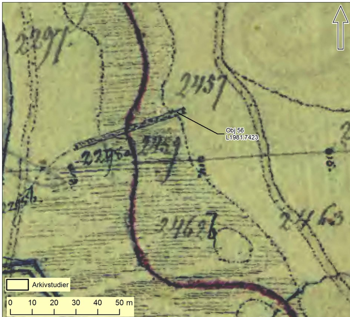
Figur 99. Detalj ur karta från år 1857. Tvärs över en bäcken, där vatten nedrinner till Tvärån, har en fördämningsvall (objekt 56) anlagts i syfte att reglera vattenflödet. Skala 1:1 000.
