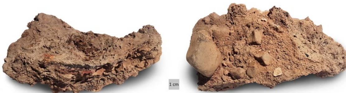
Figur 11. Bottenskålla, vilken vägde nästintill 1 kilo. Till vänster ses dess överdel med undersidan till höger. På undersidans botten var moränmaterial integrerat i slaggmaterialet.
