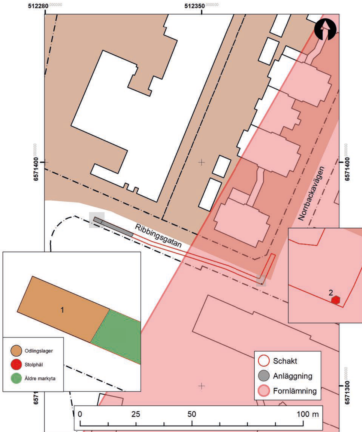
Figur 12. Schakt- och anläggningsplan, Ribbingsgatan. Skala 1:1 000 och 1:100 infälld.
