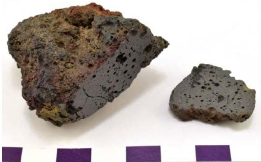
Figur 10. Prov A41s efter sågning. Högra delen preparerades till tunnslip medan den vänstra analyserades totalkemiskt. Denna slag förefaller mer trögfluten.
