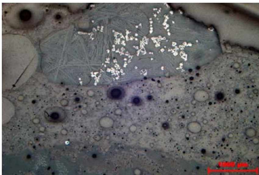
Figur 14. Slagg A10s2 där en droppe/flöde i övre delen av bild ses bestå av grå olivinlameller, mörk mellanmassa (glas) samt ljusa kantiga magnetitkristaller. Nedre delen av bilden representerar större delen av provet och ses bestå av en glasig, porig smälta.
