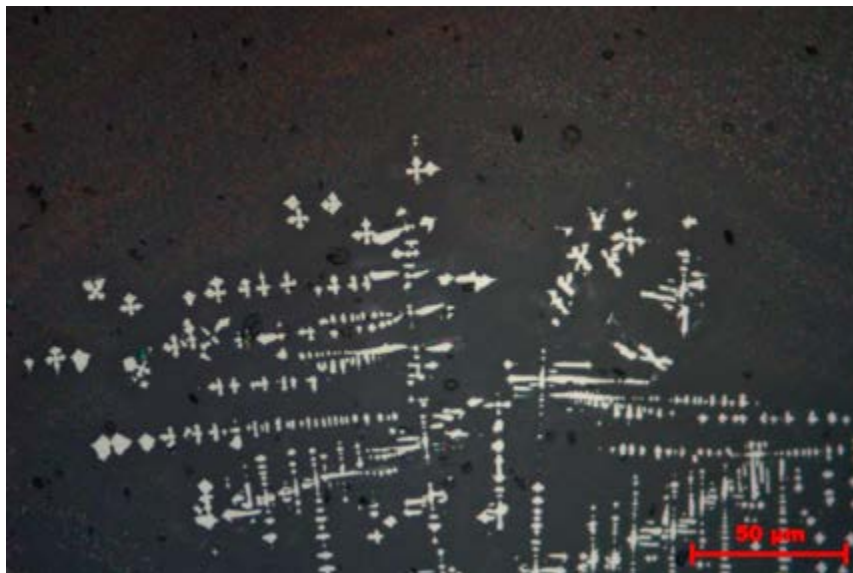
Figur 16. I mycket hög förstoring kan dendritiskt växande magnetit ses växa i den glasiga smältan.
