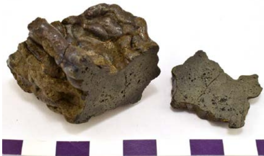
Figur 8. Slagg A10s efter sågning. Högra delen preparerades till tunnslip medan den vänstra analyserades totalkemiskt. Slaggen ses på ytan vara fluten/stearinlik. Jämför prov A10s2 från samma anläggning (fig. 9).
