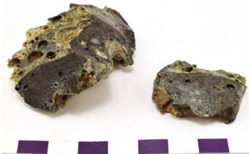
Figur 9. Prov A10s2 efter sågning. Högra delen preparerades till tunnslip medan den vänstra analyserades totalkemiskt. Notera att detta prov är glasigare än A10s från samma anläggning (fig. 8).
