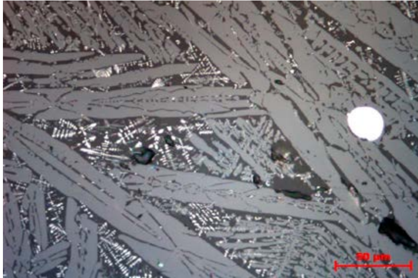
Figur 12. I mycket hög förstoring ses slag A10s bestå av grå olivinlammeller med en mörk mellanmassa bestående av glas (restsmälta). Ljusa wüstitkristaller ses huvudsakligen växa i glaset och med dendritiska former. Observera den ljusa/vita runda droppen av metalliskt järn till höger i bild.
